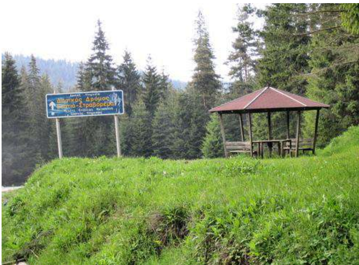
Φωτό 9: Τυπικό εξαγωνικό ξύλινο στέγαστρο (κiosκι) των δασικών μονοπατιών. Στην μελετώμενη περίπτωση θα κατασκευαστεί το ήμισυ ενός οκταγωνικού kiosκι.
