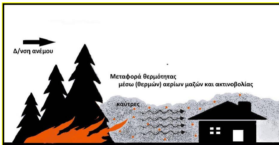
Σχέδιο 4. Τρόποι ροής της θερμότητας σε μια δασική πυρκαγιά, που εξελίσσεται πλησίον κτιρίου και απεικόνιση πιθανού τρόπου μετάδοσης δασικής πυρκαγιάς με μεταφερόμενες καύτρες σε κτίρια παρουσία ισχυρού ανέμου
